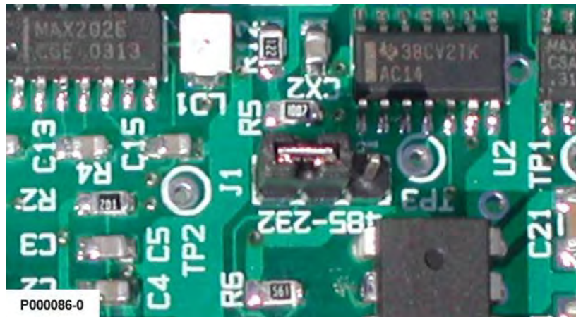
Figura 153: Configurazione jumper RS232/RS485
