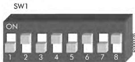
Figura 224: Impostazione del DIP-switch SW1 per acquisizione a cinque canali
