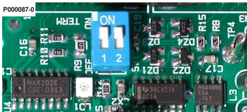
Figura 154: Configurazione DIP-switch terminatore linea RS485
