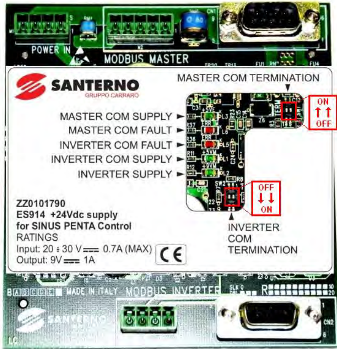
Figura 217: Posizione di LED e DIP-switch
